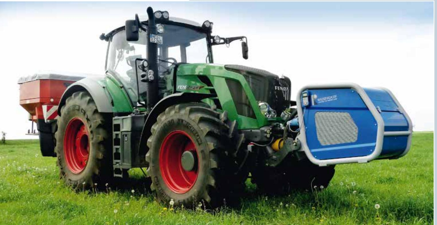
**Mobiler Zapfwellengenerator für den Front- und Heckanbau an Traktoren Leistungslieferant für elektrische Antriebe in landwirtschaftlichen und sonstigen Anbaugeräten**
